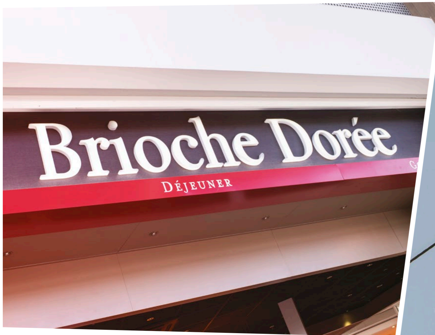
> La Brioche Dorée, Rennes Cleunay / Label Etudes Lettres PMMA bloc led's, chants opaques. Eclairage par led's
