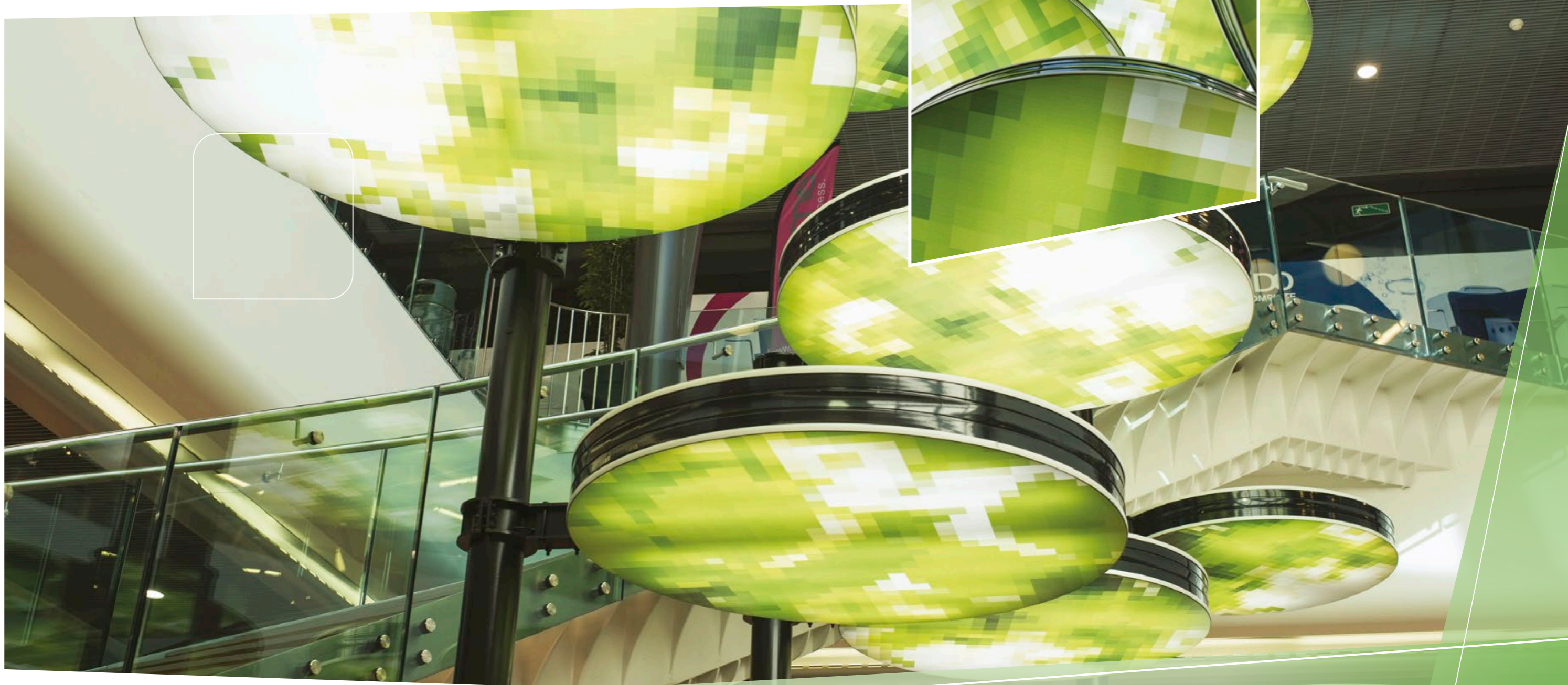
> Centre commercial Grand Quartier, St Grégoire / Wunder Architectes Ensemble de caissons en toile lumineuse fixé sur mâts acier laqués
