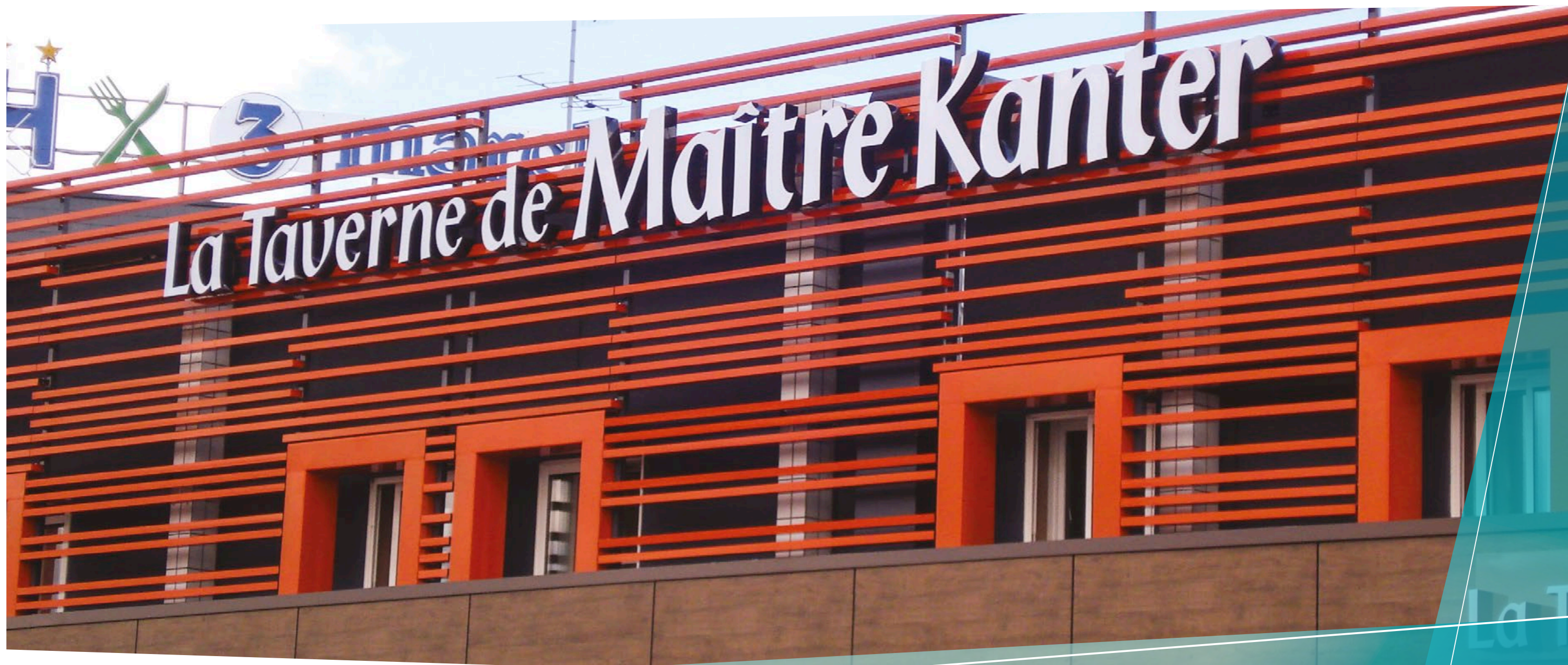
> La Taverne de Maître Kanter, Rennes Lettres boîtiers lumineuses, chant opaque et face PMMA translucide. Eclairage par led's
