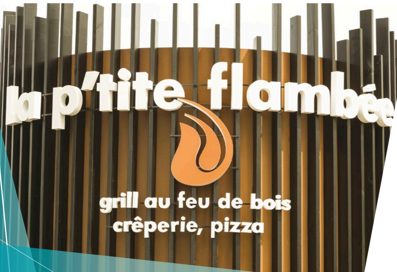
> La p'tite flambée, Cesson-Sévigné / Créacom Lettres boîtiers lumineuses, chant et face PMMA diffusant. Eclairage par led's
